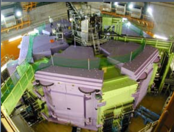
史上最も高性能な超伝導リングサイクロトロン。光速の約70%まで重イオンビームを加速できる。
