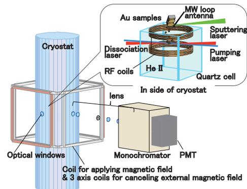
Fig. 1. Experimental apparatus.
