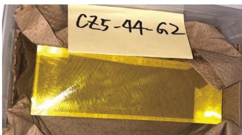
Fig. 1. The GAGG(Ce) crystal ( $40 \times 40 \times 120 \text{ mm}^3$ ).
