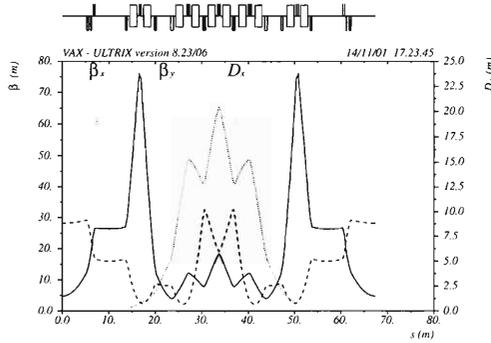
Fig. 2. Twiss parameters of the ACR.
